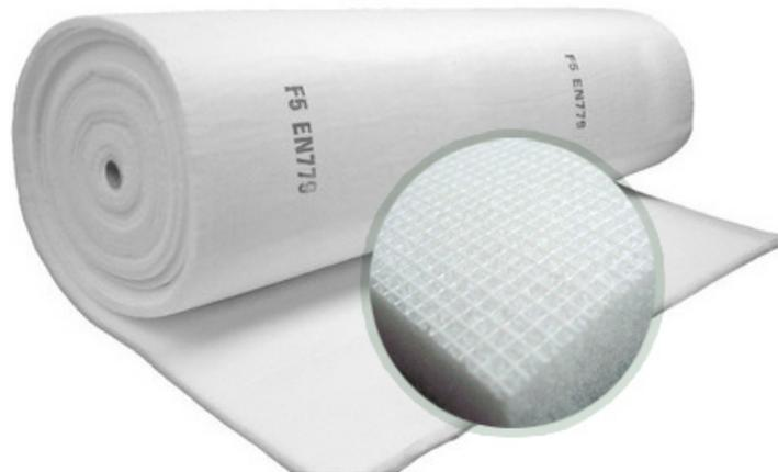
Los filtros manta Viledon F5, NF600, de clase EN 779, posee un Grado de separación de casi 10,5 micras. Su capacidad de acumulación de polvo excepcional y su estructura progresiva consiguen alargar el tiempo de vida útil del filtro. Es el filtro manta utilizado por excelencia en las Cabinas – Hornos, en los sistemas de inyección de aire limpio en recintos presurizados, y es la referencia absoluta para constructores del sector automovil.
